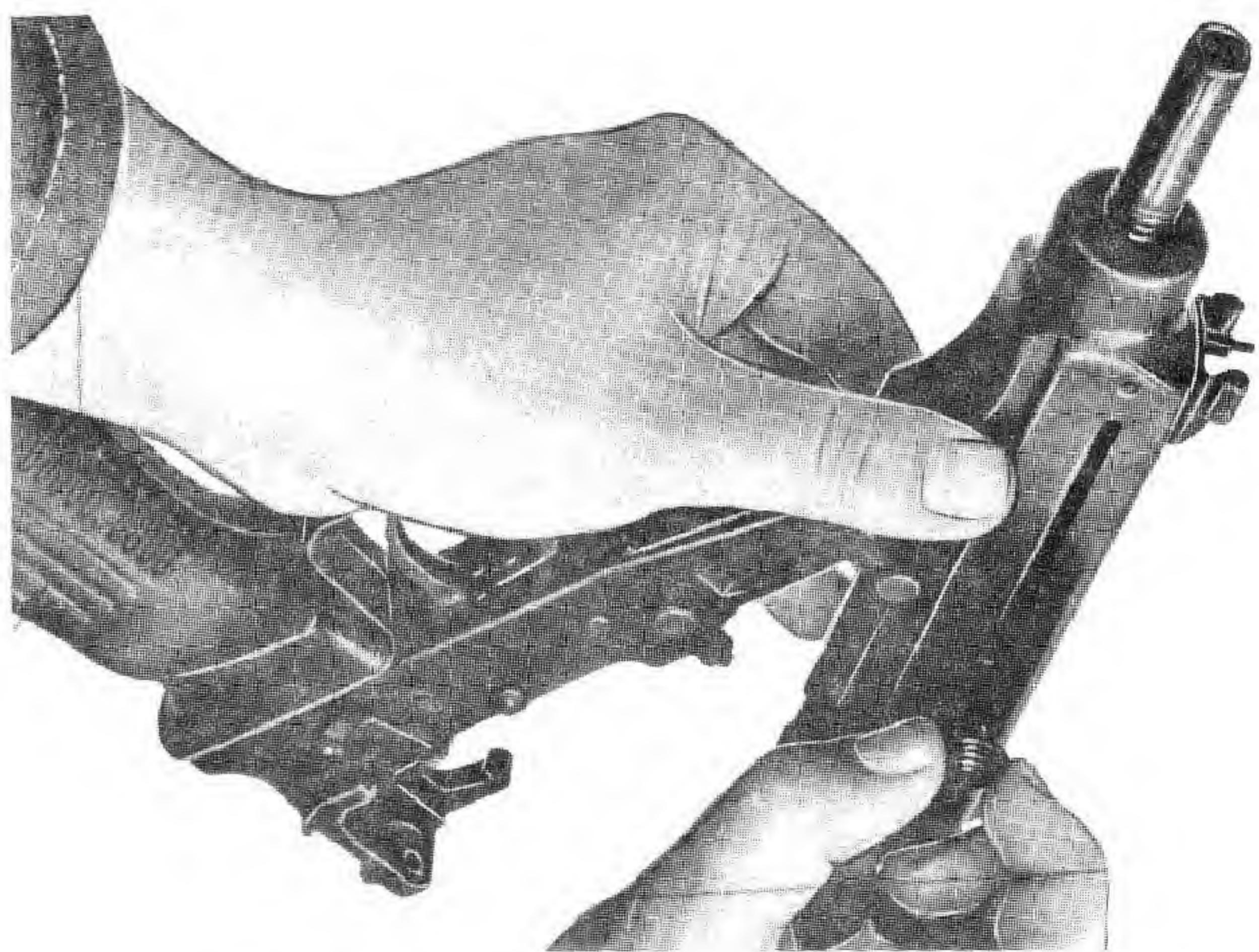
Sl. 53 – Odvajanje hvatača za povlačenje zatvarača
